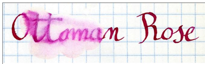
La prova di tenuta all'acqua (a sinistra) ha evidenziato una prestazione appena discreta: i cinque minuti standard di permanenza delle gocce d'acqua hanno completamente "indebolito" il testo e prodotto vistose sbavature colorate anche se viene preservata una certa leggibilità.
